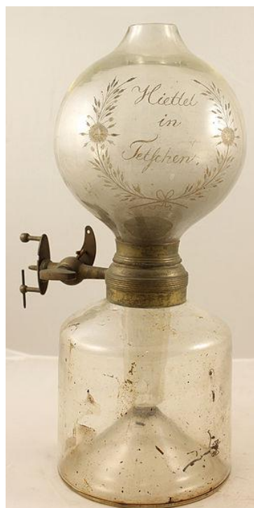
Obr. 2 Döbereinerova lampa (a – skleněná nádoba s kyselinou, b – láhev s otevřeným dnem, c – závěs, d – zinek, e – uzavírací kohout, f – tryska, g – platinová houba) [2]
