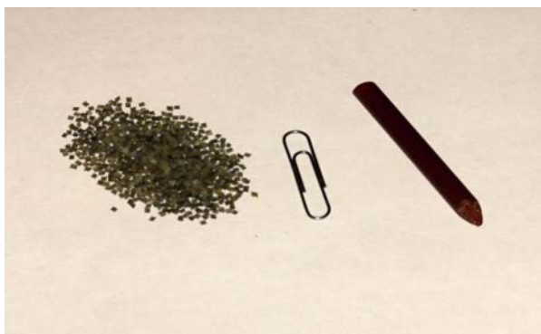
Obr. 1 Bezdýmý střelný prach (vlevo – náplň střely do samopalů; vpravo – dělostřelecký prach ve formě slisované trubičky). Pro názornost na obrázku uprostřed kancelářská sponka.
