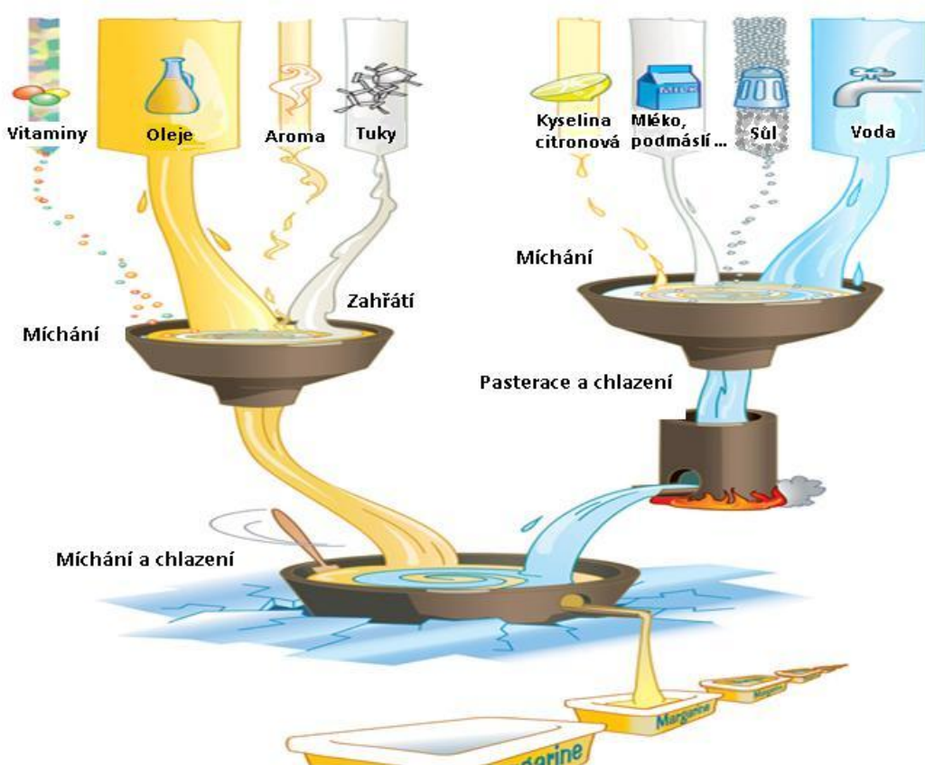
Obrázek 3: Výroba rostlinných tuků (převzato z [7])
