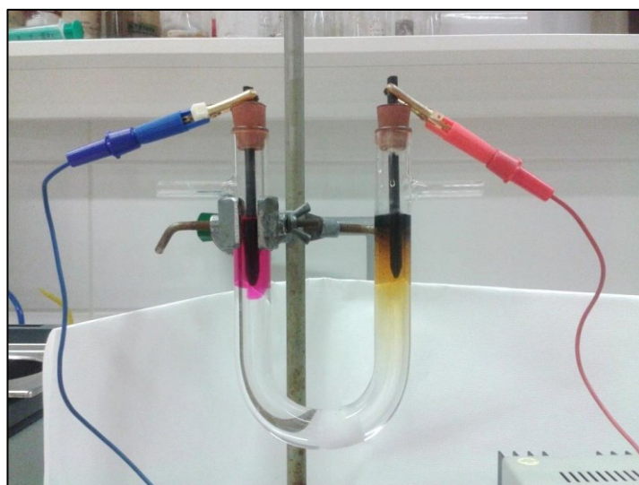
Obrázek 11: Uspořádání pokusu elektrolýzy
