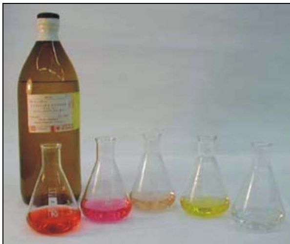
Obrázek 5 Kyseliny způsobují různé zbarvení indikátorů zleva: methyloranž, methylčerveň, lakmus, bromthymolová modř, fenolftalein.
